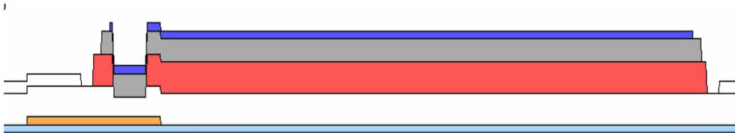
**Fig. 3.1. Cantilever realizzato mediante tecnica PolyMUMPs. Si notano tutti gli strati caratteristici: i tre strati strutturali di polisilicio Poly0, Poly1 e Poly2 (rispettivamente arancione, rosso e grigio), i due strati di ossido sacrificale in bianco, lo strato dielettrico di nitruro di silicio in azzurro e la metallizzazione finale d'oro in blu**
