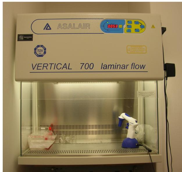
**Fig. 6.2** Cappa a flusso laminare verticale
